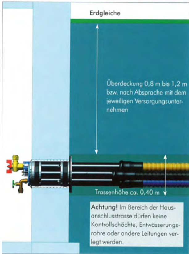
Abb. 1: Einbau Quadro-Sicura® Nova
